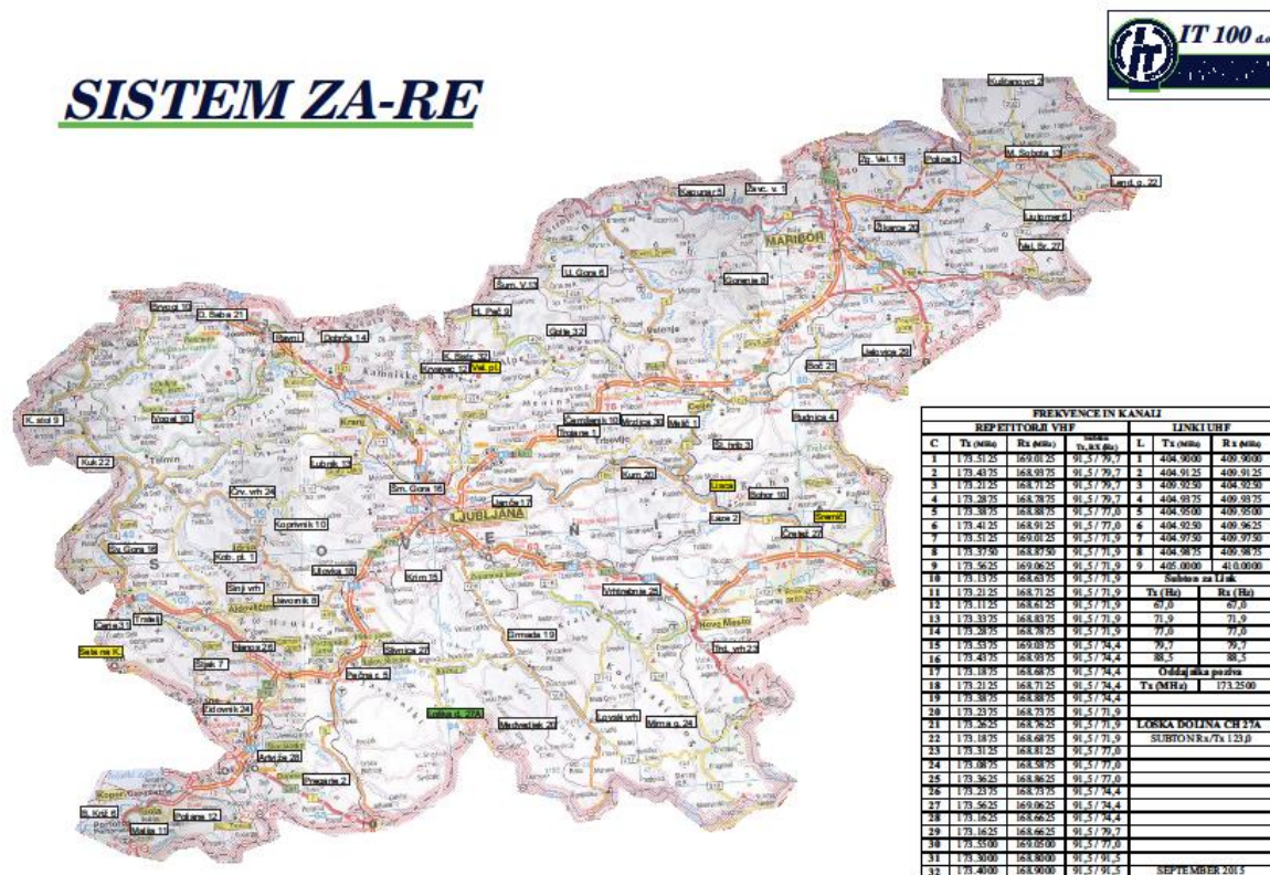
Slika 3: Repetitorske postaje s kanali sistema ZA-RE
